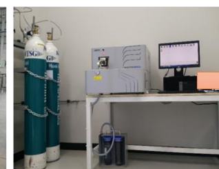
⑩ การวิเคราะห์ส่วนประกอบเคมีน้ำอะลูมิเนียมเหลว
