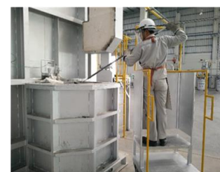
⑩ การวิเคราะห์ส่วนประกอบเคมีน้ำอะลูมิเนียมเหลว
